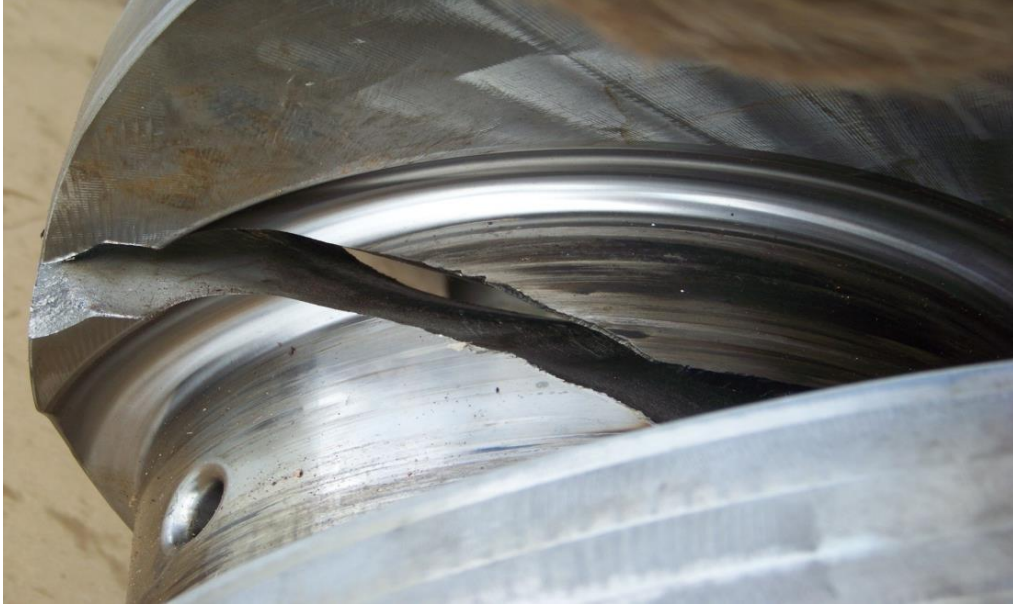
Şekil 6. Çatlamış krankı açma işlemi sırasındaki durum.
