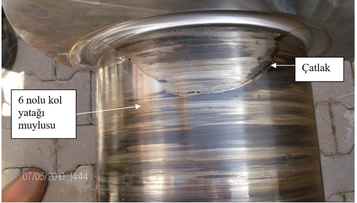
Şekil 10. Sarmış 6 numaralı kol yatağı muylusu
