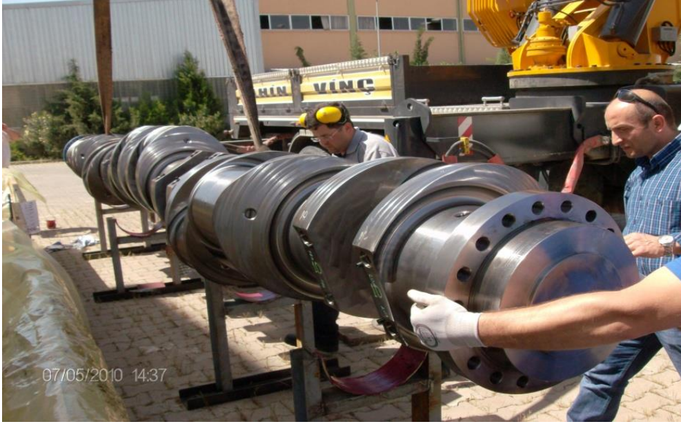
Şekil 1. Askıya alınmış hasarlı krank mili
