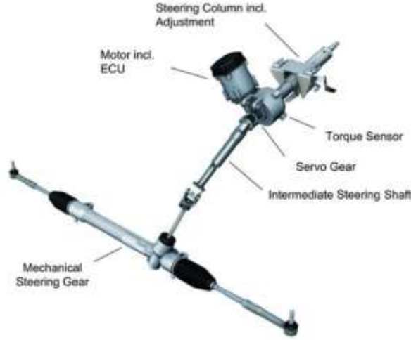
Şekil 1. Kolon tipi EPS ve mekanik direksiyon kutusu birleşimi (Harrer & Pfeffer, 2017).
