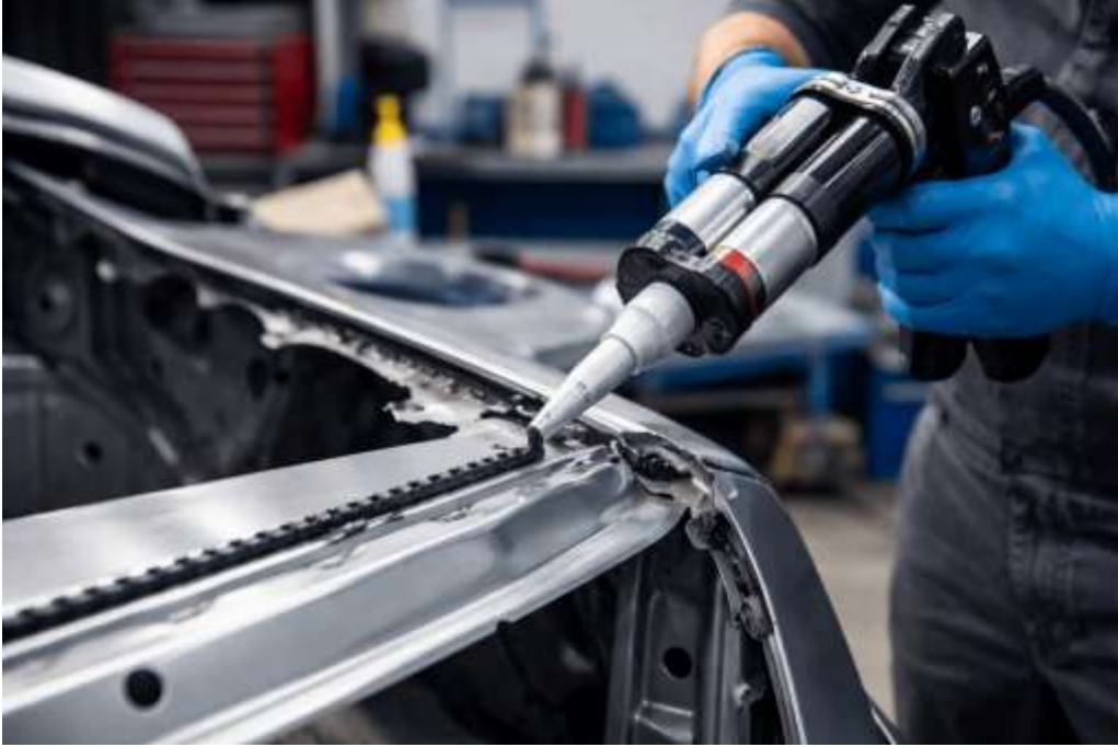
Şekil 1. Yapısal Macun Uygulaması
