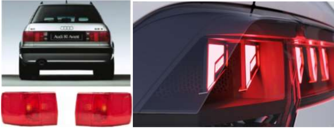
Şekil 1. Otomotiv arka lambalarında renkli dış lens (geleneksel) ve şeffaf dış lens (güncel) tasarımlarının karşılaştırması (Audi, 2003; RD AUTO LIGHT SYSTEM, t.y.).
