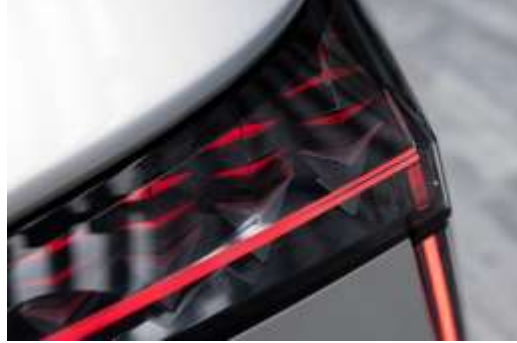
Şekil 2. Otomotiv arka lamba yapısı — Dışta şeffaf/siyah PMMA lens, içeride şeffaf PMMA optik gövdeler, kırmızı PC çerçeve üstü siyah kaplama (Lasercoating, UV koruma) (Clymo, R., 2025).
