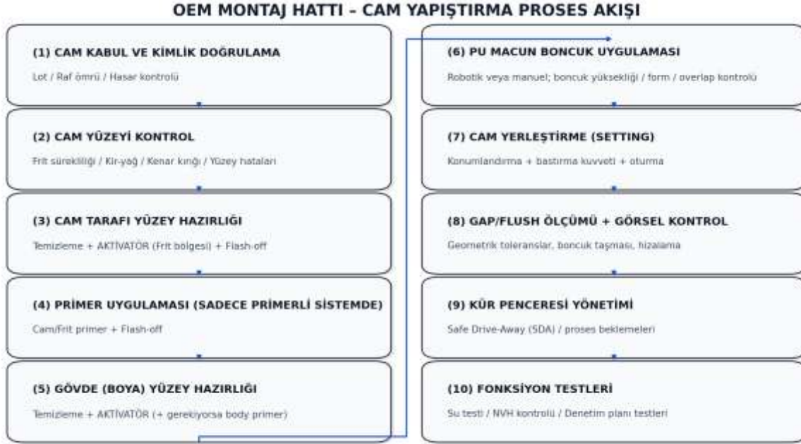
Şekil 1. Montaj Hattı- Cam Yapıştırma Proses Akışı
