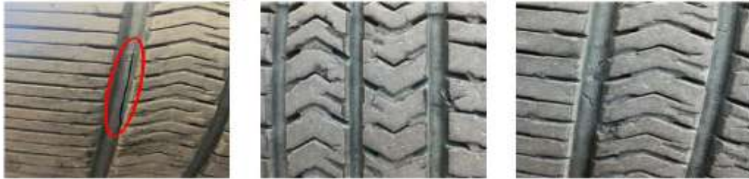
Şekil 3. Lastik aşınma ölçüm noktaları ve farklı lastiklere ait aşınma karşılaştırma sonuçları.
