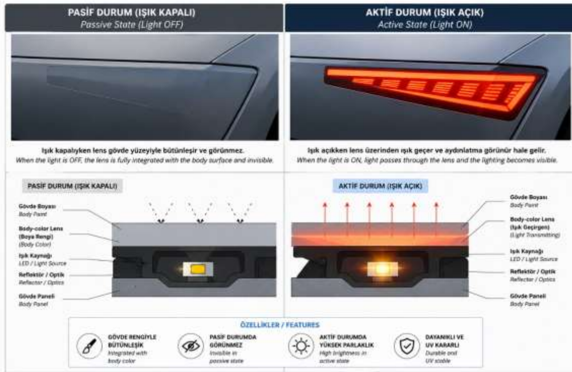
Şekil 2. Body-color lens yapısının pasif ve aktif durum karşılaştırması.
