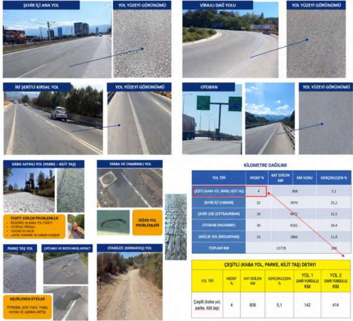
Şekil 2. Test güzergâhlarında kullanılan farklı yol yüzeyleri ve kilometre dağılımlarına ait örnekler.
