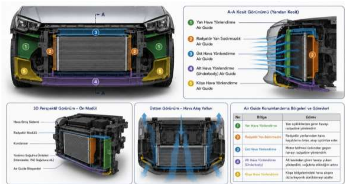
Şekil 5. Araç Ön Modülünde Air Guide Konumlandırma Bölgeleri
