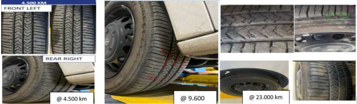
Şekil 4. Chip & Chunk probleminin analiz süreci ve farklı kilometrelerde gerçekleştirilen saha gözlemleri.
