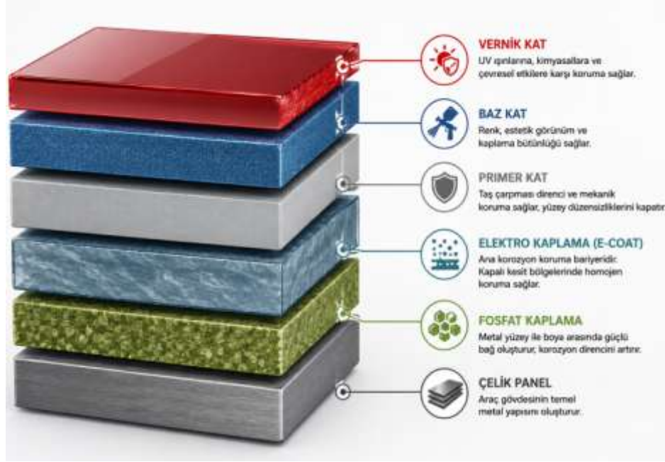
Şekil 4. Otomotiv araç gövdelerinde kullanılan çok katmanlı boya sistemi yapısı.
