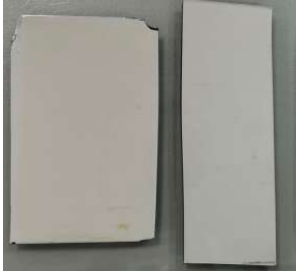
Figure 16: UV katkı miktarı arttırılmadan önce ve UV katkı miktarı arttırılmış test sonrası numune
