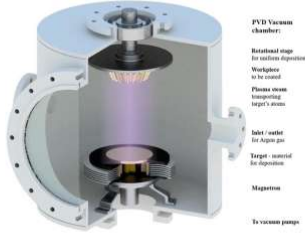
Şekil 16 Vakum Odası Şematik Gösterimi [2]
