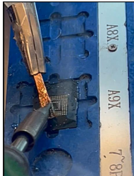
Şekil 19-Lehim Toplayıcı ile Çipin Ayaklarının Eşitlenmesi
