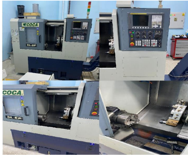
Şekil 4. Tornalama işleminde kullanılan CNC torna
