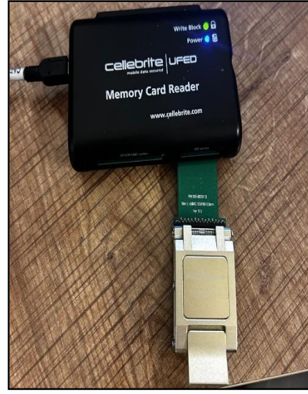
Şekil 22-Sireda ile Çipin Bilgisayara Okutulması
