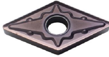
Şekil 2. DNMG150608-OMM P25-M25 sert metal karbür uç
