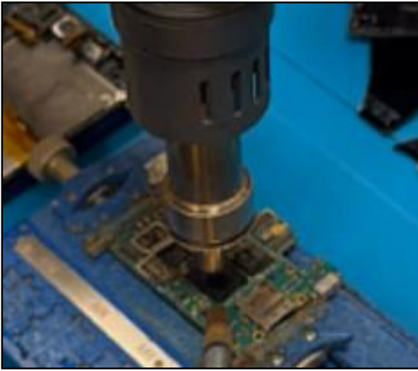
Şekil 18-Çipin Board Üzerinden Ayrılması
