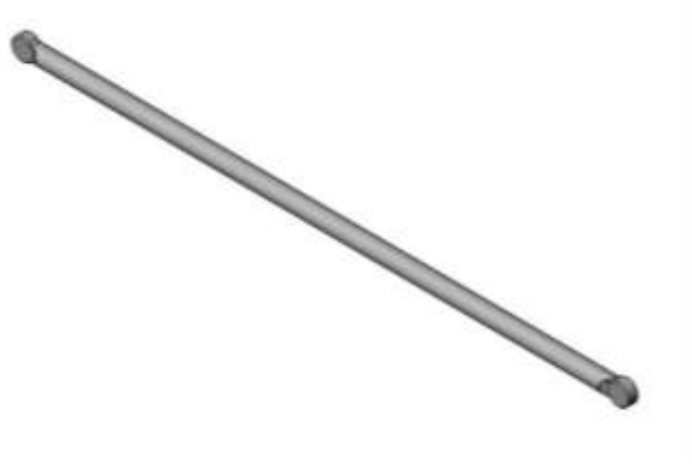
Şekil 1. Tasarımı tamamlanan viraj denge çubuğu
