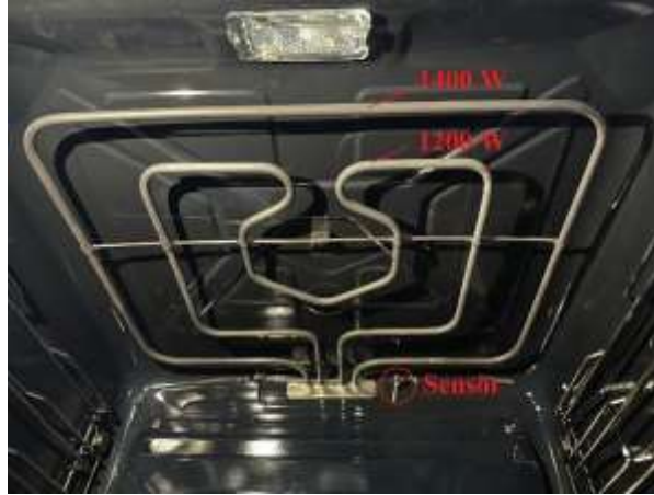
Şekil 1. Titanyum cata model üst rezistansları ve ısı sensörü
