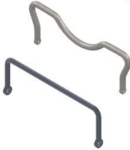
Şekil 2. Üretim prosesleri tamamlanan viraj denge çubuğu örnekleri
