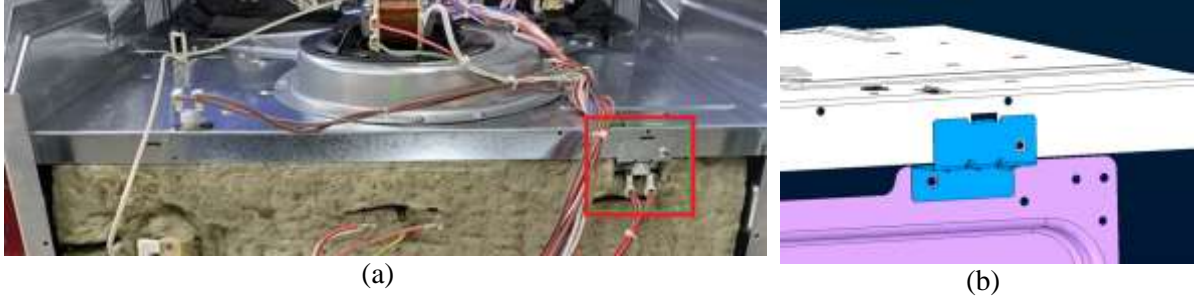
Şekil 1. Röle ve braket montaj yeri (a) Fırın arka görünüm, (b) Röle montaj braketi
