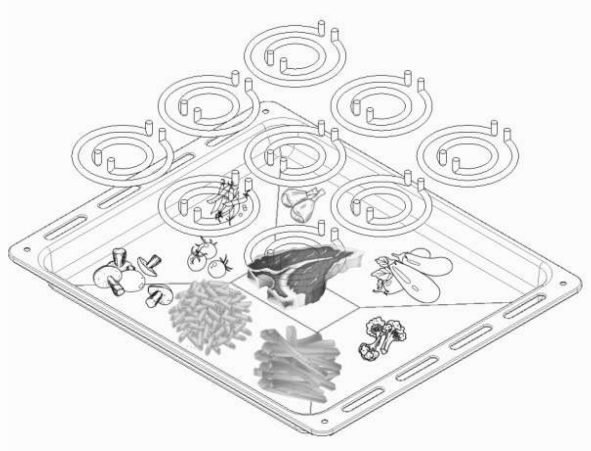
Şekil 5. Pişirici cihazlarda akıllı rezistans sistemi (Patent başvuru numarası: 2023/007549)
