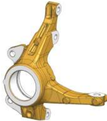
Şekil 4: Çalışmada kullanılacak, NX programıyla tasarlanan Akson 3D modeli
