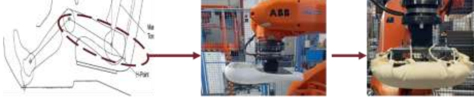
Şekil 5. H-point'e göre tasarlanmış manken formu ve kullanıcı kıyafetini simüle eden tekstil giydirme
