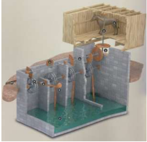
Şekil 5-6. Dört Keçeli Su Yükseltme Düzeneği (Çalışkan, 2019: 300,302)
