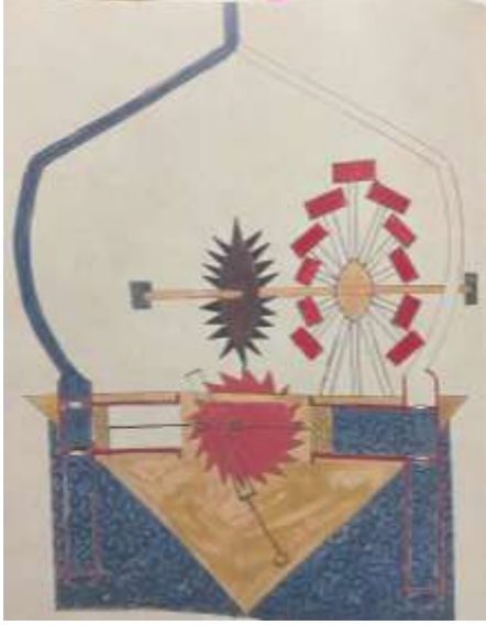
Şekil 11-12. Çift Etkili Su Yükseltme Pompası (Çalışkan, 2019: 312, 314)
