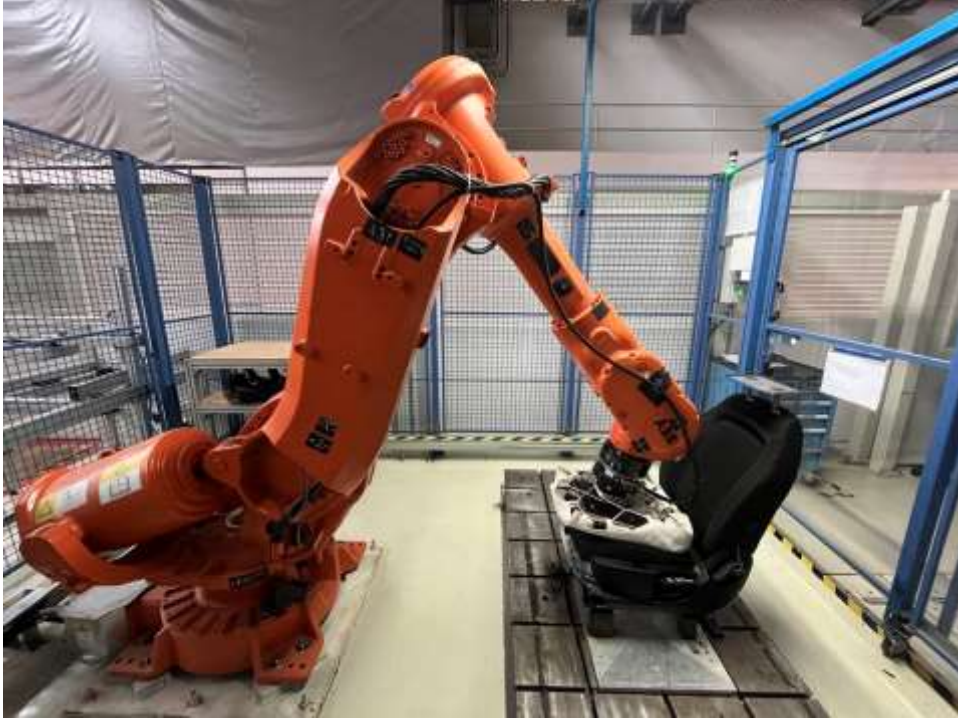
Şekil 6. Tasarım pozisyonuna göre kurulmuş koltuk kompleksi ve endüstriyel robota bağlı manken formu
