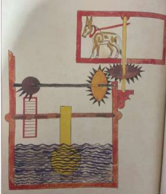
Şekil 4-5. Tek Kepçeli Su Yükseltme Düzeneği (Çalışkan, 2019: 294,296)
