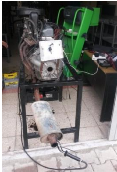
Şekil 3a. Buji ateşlemeli motor Şekil 3b. Deneylerde kullanılan üç tırnaklı bujiler
