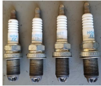
Şekil 3b. Deneylerde kullanılan üç tırnaklı bujiler
