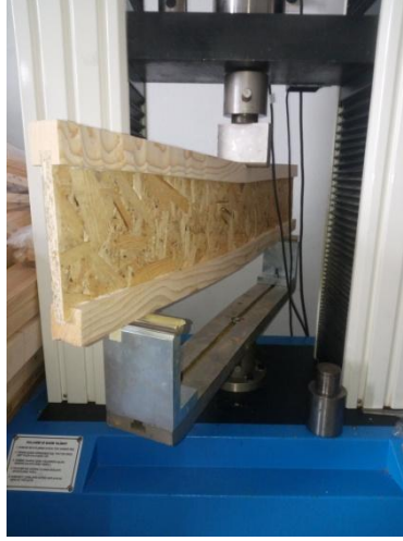
Şekil 3. 3 noktadan eğilme deneyi
