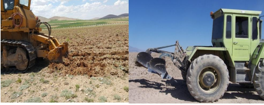
Şekil 2. Riperle alt-toprak (sol) ve pullukla üst-toprak işleme
