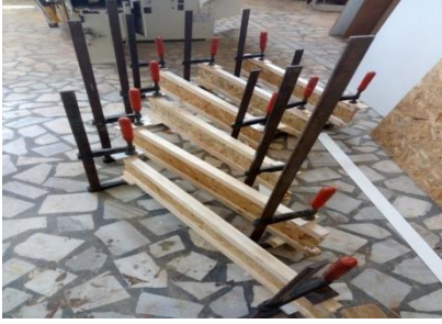
Şekil 2. İşkence ile yapıştırma işlemine tabi tutulan I kiriş örnekleri.
