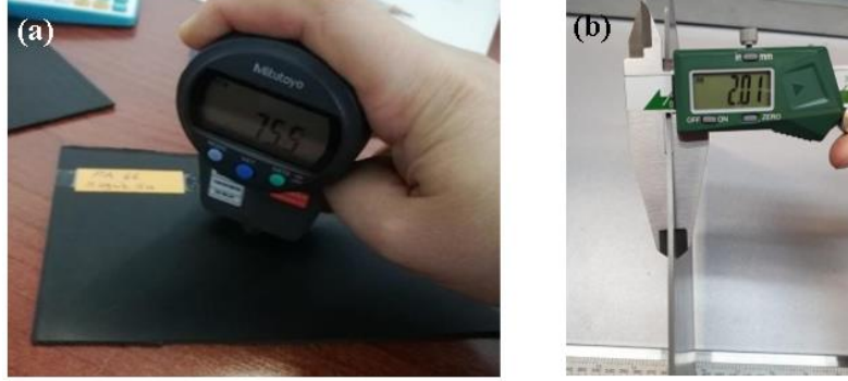
Şekil 1. Plastik enjeksiyonla üretilen (a) bağlantı destek levhası ve (b) dijital kumpasla ölçümü
