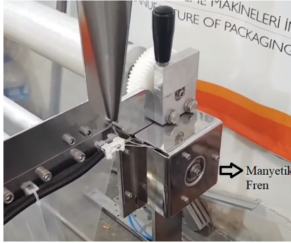
Şekil 6. Tasarlanan sürekli paketleme makinası manyetik ambalaj fren tertibatı
