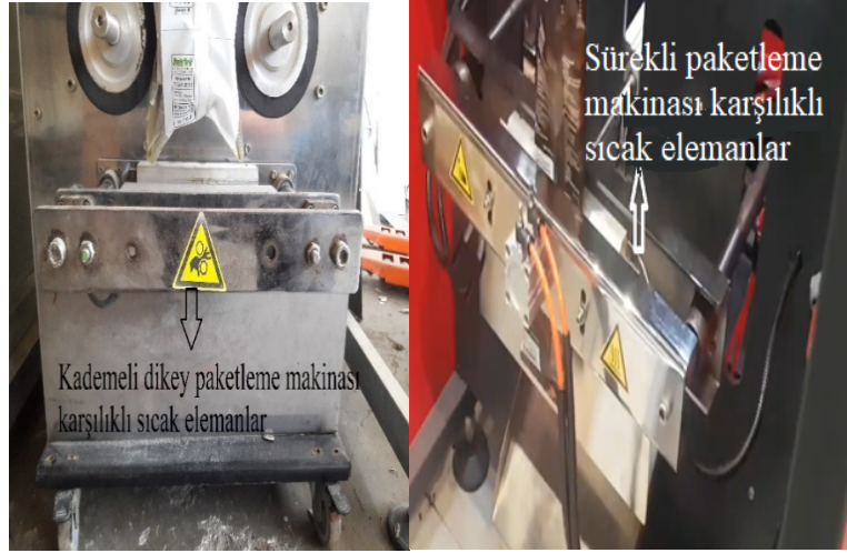
Şekil 10. Kademeli ve sürekli dikey paketleme makinası karşılıklı sıcak elemanlar
