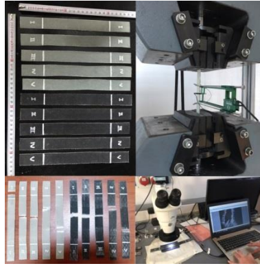
Şekil 3. Çekme testi ekipmanları ve numune analizi
