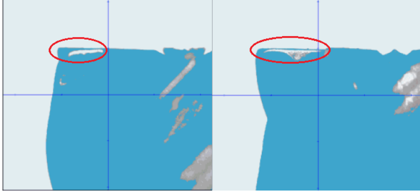
Şekil 12. Freze çakısı alın aşınması katkılı kompozit kesim
