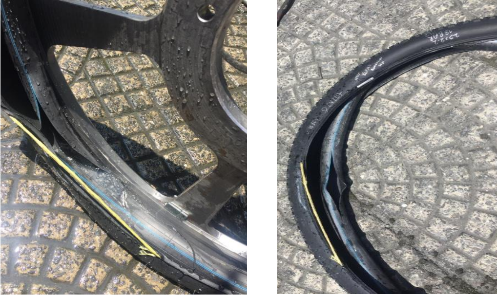
Şekil 16. NY6-235x1-3500 konstrüksiyonlu Aramid topuk test sonu görseli.
