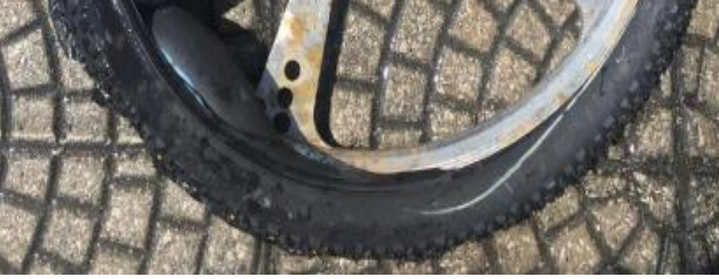
Şekil 11. NY6-940x1-870 konstrüksiyonlu Çelik telli topuk test sonu görseli
