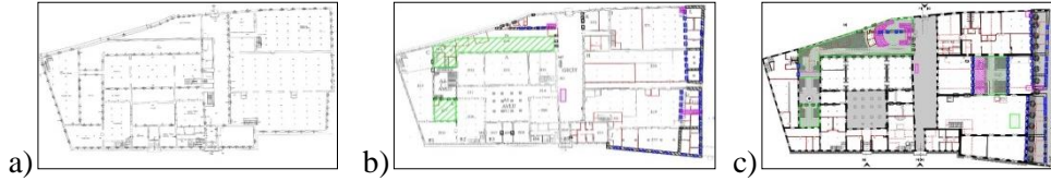
Şekil 12: Cibali Tütün ve Sigara Fabrikası Zemin Kat Planı Analizleri a) Restitüsyon projesi, b) Rölöve projesi, c) restorasyon-yeniden işlevlendirme projesi (Projeler Tures Mimarlık'tan alınmıştır.)
