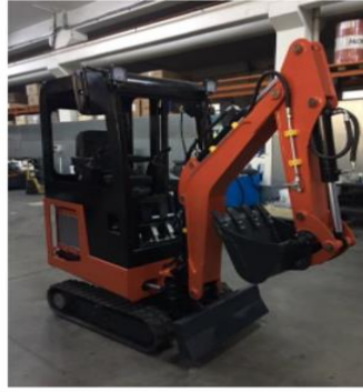
Şekil 9. Prototip olarak imal edilen mini ekskavatör
