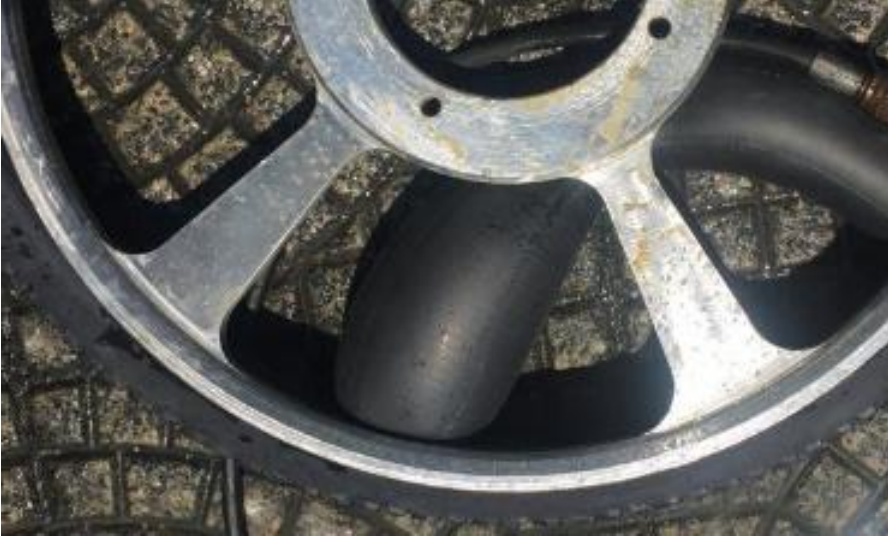
Şekil 13. NY6-470x1-2000 konstrüksiyonlu Çelik telli topuk test sonu görseli.
