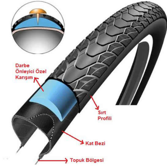
Şekil 1. Bisiklet lastiğini oluşturan bileşenler.
