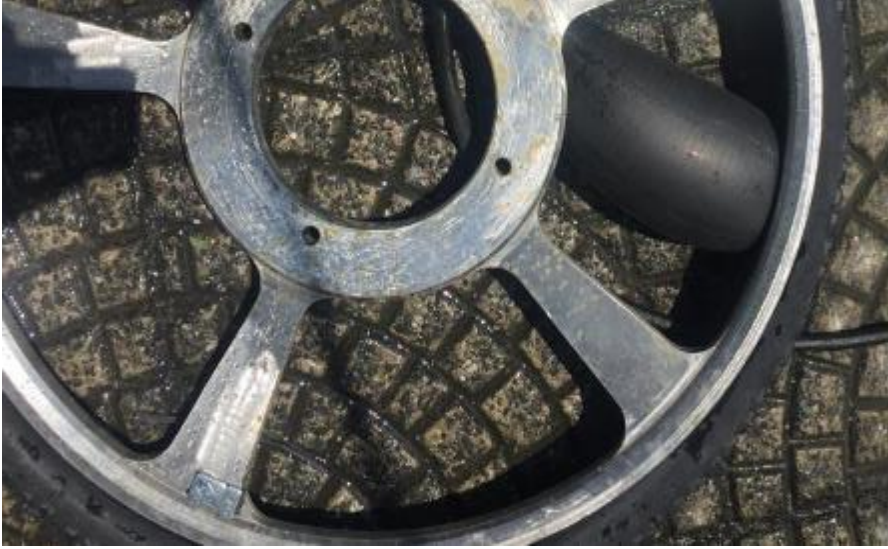
Şekil 14. NY6-470x1-2000 konstrüksiyonlu Aramid topuk test sonu görseli.
