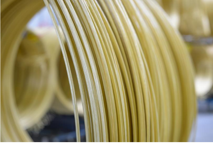
Şekil 7. Katlanabilir bisiklet lastiklerinde kullanılan aramid topuklar [14].
