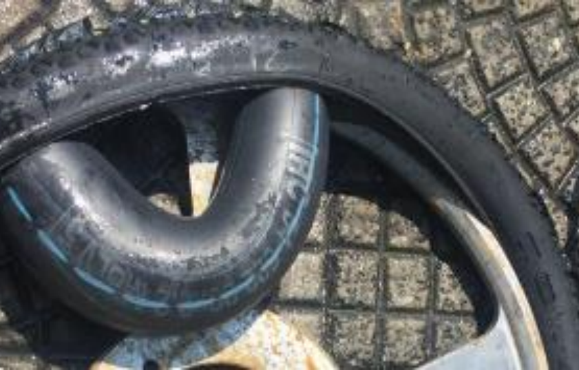
Şekil 12. NY6-940x1-870 konstrüksiyonlu Aramid topuk test sonu görseli.
