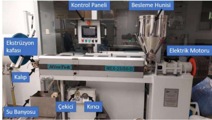
Görsel 6. Kompaunder Makinesindeki Bölümler [1]
