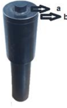
Şekil.4 SKNK takımının görüntüsü a) pin, b) omuz
