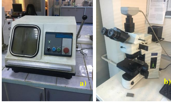
Şekil 7. a) Numune kesme işlemi yapılan cihaz, b) Mikroyapı görüntüleri alınan mikroskop cihazı.
