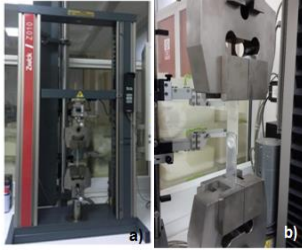
Şekil 5. (a).Zwick Z010 Çekme test cihazı,(b)Cihaza bağlanmış test numunesi
