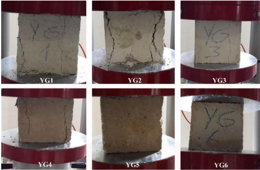
Şekil 2. Tek eksenli basınç deneyi sonucunda harç numunelerinde meydana gelen hasar biçimleri.
