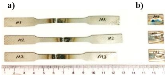
Őekil 9. Manuel olarak kaynaklı birleřtirmesi gerekleřtirilen numunelerin çekme testi sonrası görüntleri a) Manuel olarak birleřtirilmiř çekme numunelerinin kopması b) Mikroyapı kesitlerinin alınması.
