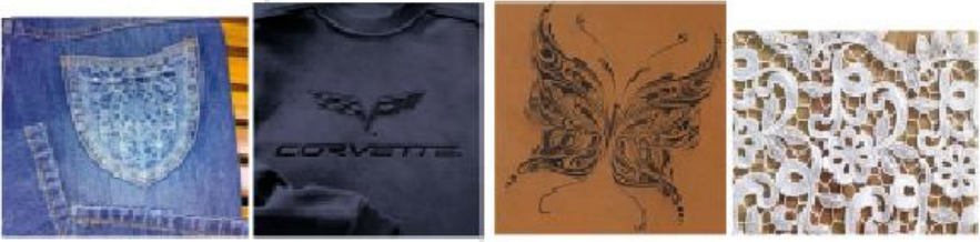
Resim 3. Lazer kesim ve baskı örnekleri (Nayak ve Padhye, 2016)
