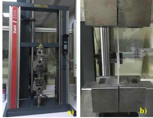
Şekil 5. a) Zwick Z010 model çekme test cihazı, b) Makine çenesine bağlanmış test numunesi.
