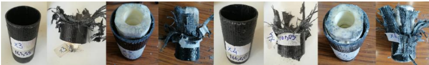
Şekil 2. Poliüretan köpük takviyesiz ve takviyeli karbon fiber çarpışma kutularının düşme testi öncesi ve sonrası fotoğrafları
