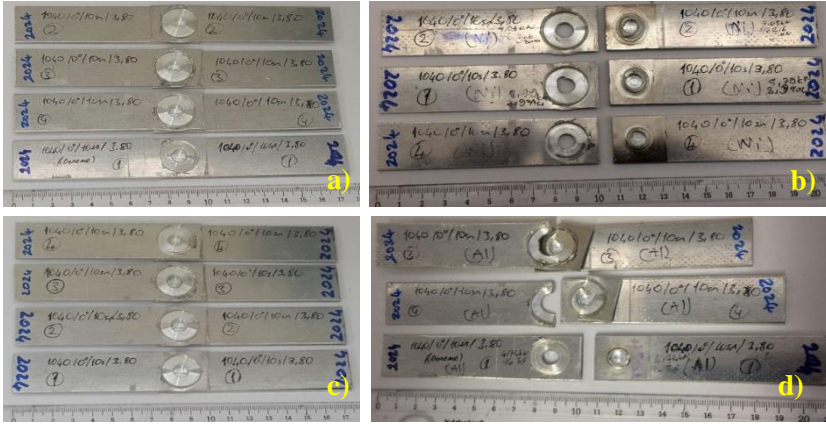
Şekil 6. a) Çekme-makaslama testi öncesi AA2024-T3/Ni/AA2024-T3 kaynaklanmış numuneler, b) Çekme-makaslama testi sonrası AA2024-T3/Ni/AA2024-T3 birleştirilmiş numuneler, c) Çekme-makaslama testi öncesi AA2024-T3/AA2024-T3 birleştirilmiş numuneler, d) Çekme-makaslama testi sonrası AA2024-T3/AA2024-T3 birleştirilmiş numuneler.
