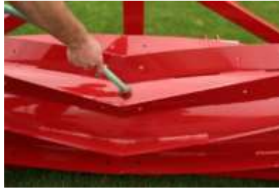
Şekil 5. Örtü bitkisi merdanesinin içerisine sıvı eklenmesi (I&J, 2017)
