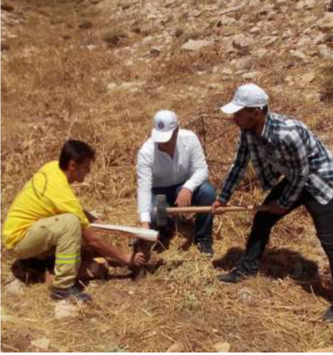
Şekil 2. Kök örnekleme için kullanılan 6,4 x 35 cm derinliğindeki çakma silindiri
